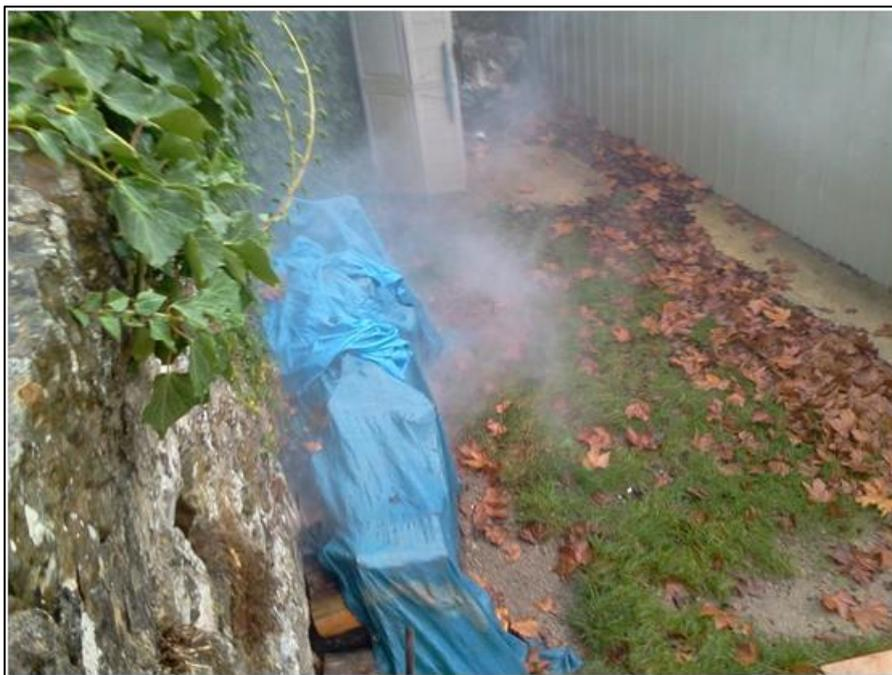
La fumée met en évidence une casse probable de la conduite d'assainissement. Cette casse peut-être à l'origine d'une introduction dans le réseau d'eau de ruissellement et d'eau de nappe.
